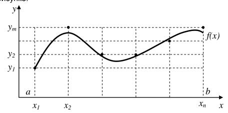
Таким образом, любое сообщение может быть представлено как дискретное; иначе говоря, последовательностью знаков некоторого алфавита. Устройство, осуществляющее преобразование аналогового сигнала в дискретный, называют аналогово-цифровым преобразователем (АЦП), а для устройства, осуществляющего обратное преобразование, часто используют аббревиатуру ЦАП.
