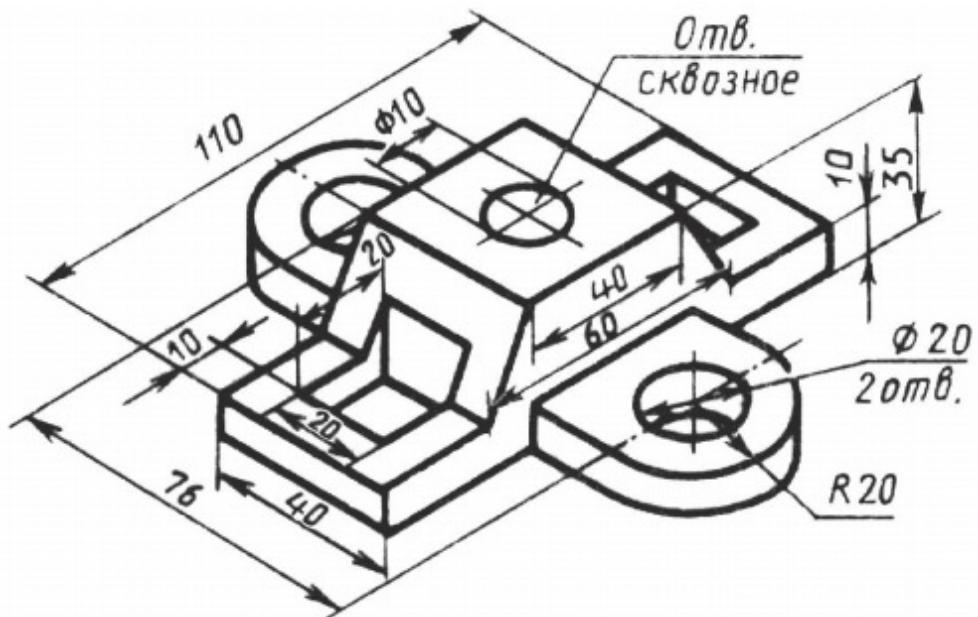
**15** В одной из систем автоматизированного проектирования постройте трехмерную модель приведенной ниже детали
