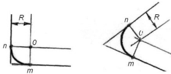
Рисунок 2.1. - Построение сопряжения прямых дугой заданного радиуса
