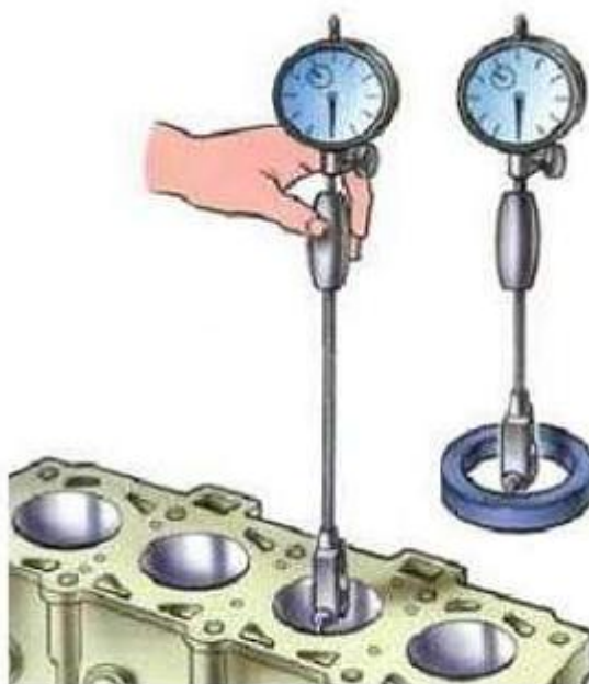
Рис. 2.4 Измерение внутреннего диаметра
