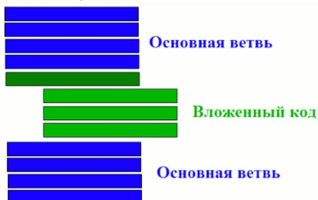
Можно изобразить блок-схему программы, содержащей инструкцию **if**, в таком виде:
