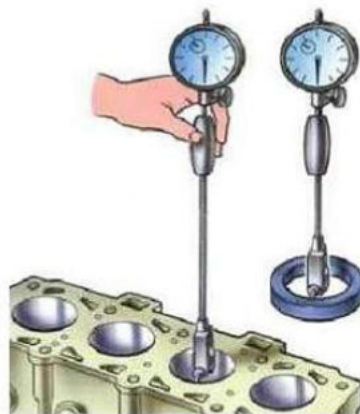
Рис. 2.4 Измерение внутреннего диаметра
