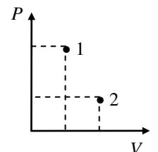
27. На глубине 40 м в стоячей воде пузырек воздуха имеет объем 3 мм<sup>3</sup>. Определить объем этого же пузырька при подъеме его на поверхность воды. Процесс считать изотермическим, атмосферное давление  $10^5 \text{ Па}$ . [15 мм<sup>3</sup>]
