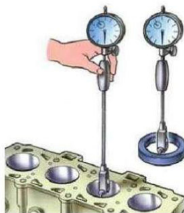
Рис. 2.4 Измерение внутреннего диаметра
